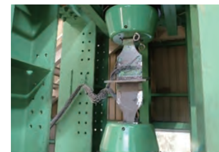
溶接継手部の疲労試験
