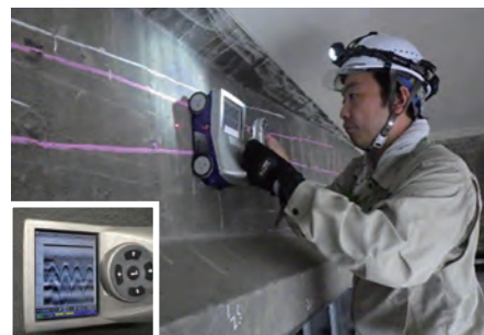
電磁波レーダによる鉄筋探査
