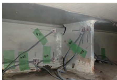
鋼桁の応力モニタリング
