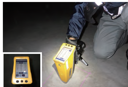
蛍光X線分析による塩分量測定
