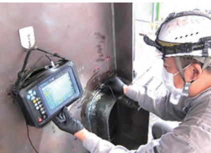
超音波探傷試験（鋼桁切欠き部の溶接部）
