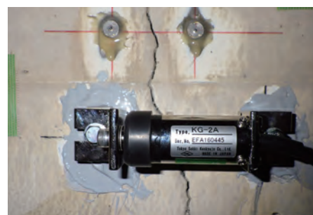
コンクリートひび割れ幅 変位計測
