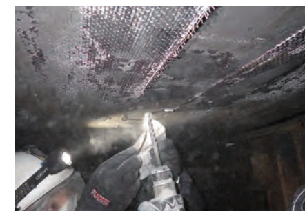
火災により被害を受けた RC 床版 （ドリル法による中性化測定）
