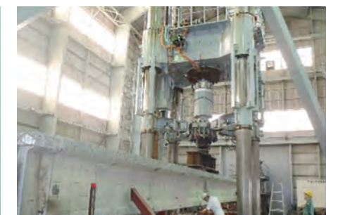
撤去した PC 桁の載荷試験
